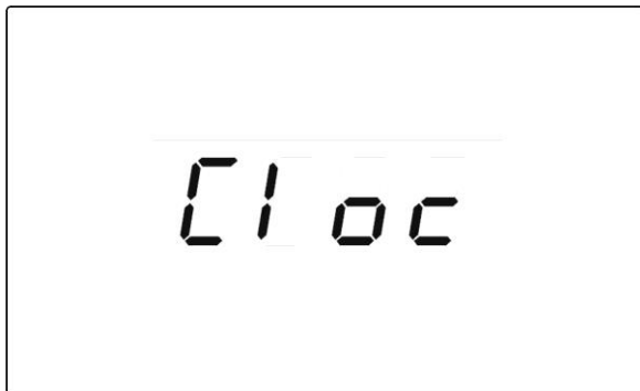
fig. 29 – Parámetros Cloc . La pulsación prolongada del botón Arranque/parada permite acceder a los parámetros (identificados en este caso como C1 , C2 , etc.). El parámetro C1 se refiere al año en curso, C2 al mes, etc. Para modificar el parámetro, utilice los botones de Selección . Para pasar de un parámetro a otro, utilice el botón « Funciones ». Para confirmar la modificación, pulse el botón Arranque/parada .
