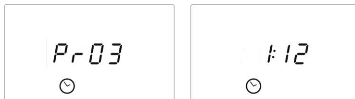
fig. 19 – Cuando se activa el ciclo, se muestra alternadamente el programa seleccionado y el tiempo que falta para el arranque efectivo.
