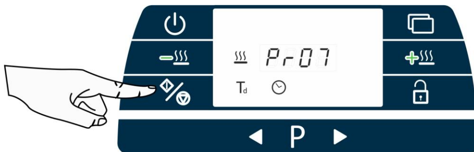
fig. 16 – Interrupción del programa mediante la pulsación prolongada del botón Arranque/parada
