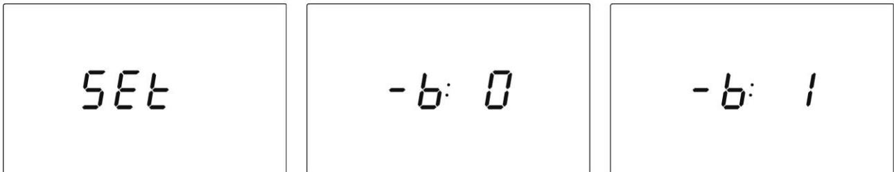
fig. 27 – Parámetros de la máquina SET : el parámetro -b configura la posibilidad de sobrescribir el archivo interno de memoria.
