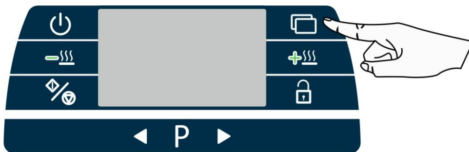
fig. 9 – Botón Funciones . Cuando el ciclo está en curso o en fase de selección, pulsando el botón Funciones se puede visualizar los parámetros del ciclo de lavado: valor A0, Temperatura, Tiempo restante.
