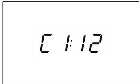
fig. 29 – Parámetros Cloc . La pulsación prolongada del botón Arranque/parada permite acceder a los parámetros (identificados en este caso como C1 , C2 , etc.). El parámetro C1 se refiere al año en curso, C2 al mes, etc. Para modificar el parámetro, utilice los botones de Selección . Para pasar de un parámetro a otro, utilice el botón « Funciones ». Para confirmar la modificación, pulse el botón Arranque/parada .
