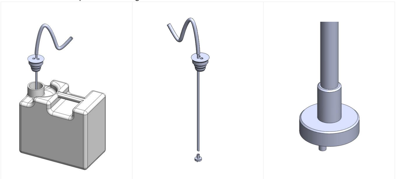
fig. 33 – Configuración ESTÁNDAR Tethys T60 de aspiración de detergentes. Colocación del tubo de aspiración de detergente en el bidón. Para obtener una colocación perfecta y segura, el tapón de goma debe coincidir con la boca del bidón. El tubo está equipado con un filtro de aspiración.
